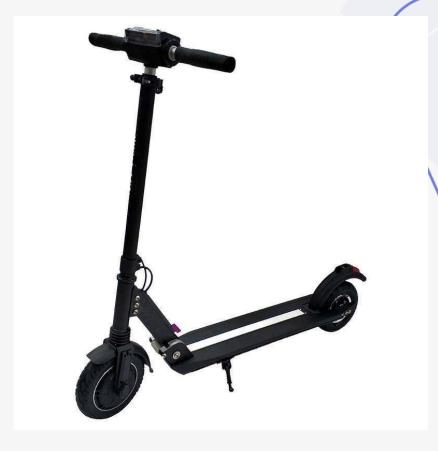
размещается непосредственно в самом колесе). Регулировать скорость электросамоката нужно при помощи специальных рычагов — газа и тормоза. Важно не нажимать на них резко. Для поворота необходимо слегка наклониться в нужную сторону и немного повернуть руль.
