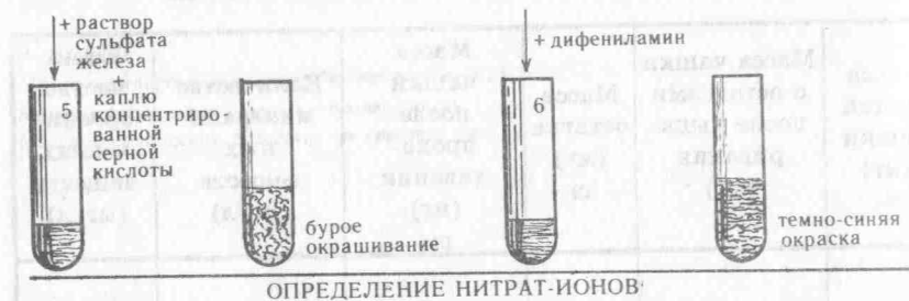
Рис. 32. Последовательность опыта по определению токсичных веществ в сточных водах
